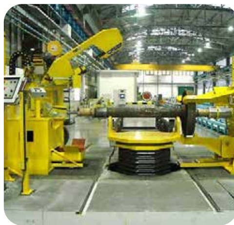
Устаткування для демонтажу коліс та різання покриття
